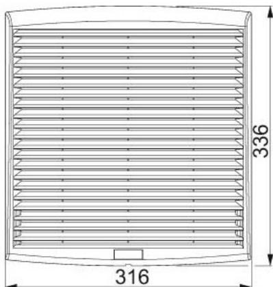
**Ventilateur filtre 780m3/h 400/440V RAL7035 - Ventilateur d'armoire NSYCVF850M400PF**
