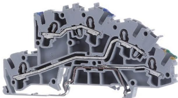
Courant nominal In 32 A, Tension nominale 400 V, Nombre de potentiels 3, Type d'installation Rail DIN TH35, Matériau du corps isolant Thermoplastique, Température de service 105 °C, Largeur 5,2 mm, Hauteur 96 mm, Profondeur 42,3 mm, Plaque d'extrémité nécessaire oui, Couleur de base gris, Avec fonction PE oui, Avec curseurs de sectionnement du neutre sans vis non, Fonction N possible oui
