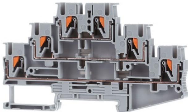
Courant nominal In 20 A, Tension nominale 500 V, Conception de connexion électrique 1 divers, Conception de connexion électrique 2 divers, Nombre d'étages 3, Nombre de bornes par étage 2, Type d'installation Rail DIN TH35, Matériau du corps isolant divers, Température de service -60..105 °C, Largeur 5,15 mm, Hauteur 102,23 mm, Profondeur 56,45 mm, Version antidéflagrante \*Ex e oui, Plaque d'extrémité nécessaire oui, Couleur gris, Étages pontés en interne non
